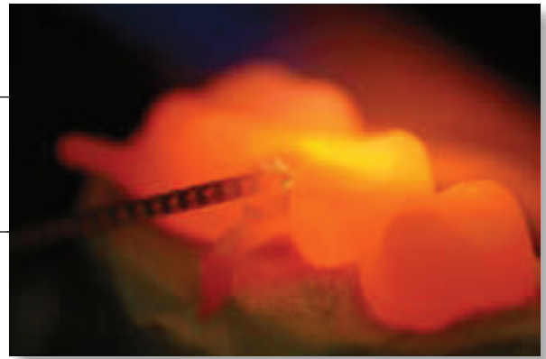
Fig. 9 Dopo un adeguato preriscaldamento effettuiamo la saldobrasatura a fiamma con apporto di saldame idoneo alla lega utilizzata.
